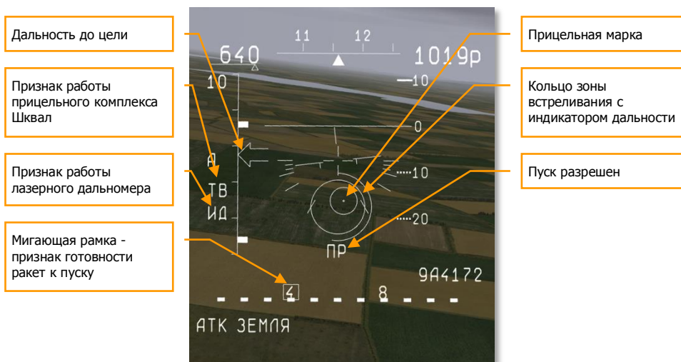
Рисунок 31: Вид ИЛС при применении ПТУР Вихрь
