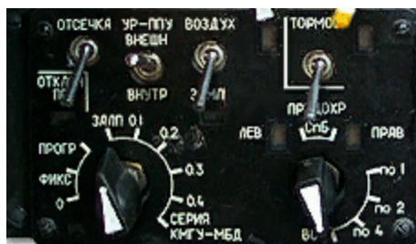
Рисунок 20: Щиток системы управления вооружением самолета Су-25Т
