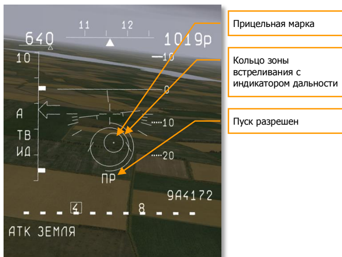
Рисунок 37: Вид ИЛС при применении ПТУР Вихрь
